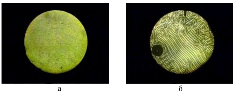
Рис. 1. Текстуры ПАА при 132°C (а) и смеси ПАА+ 5,3 % П-β-ЦД при 125°C (б)
